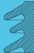
CZ - TIP KRILA ZA UVEĆANU STRUJNU STAZU BOJA GLAZURE SMEĐA ILI SIVA
